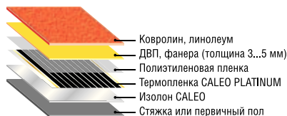
Рис. 29. Схема монтажа пленочного теплого пола под ковролин, линолеум
