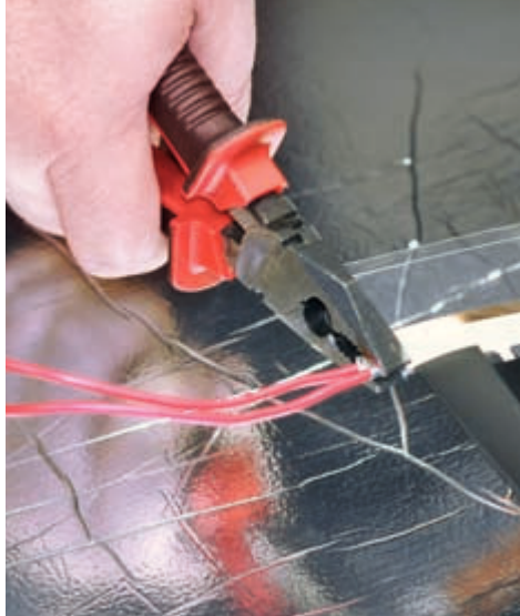
Рис. 16. Надежно зажмите провода в контактном зажиме
