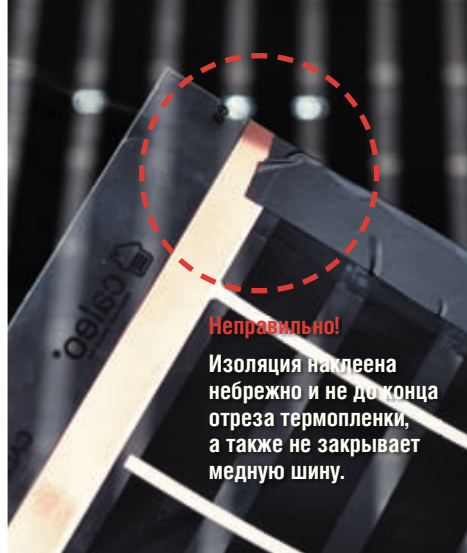
Рис. 14. Пример неправильной установки ПВХ изоляции
