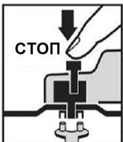
Для установки диска полностью нажмите кнопку блокировки шпинделя и непрерывно удерживайте ее в таком положении. При необходимости свободной рукой слегка поворачивайте шпиндель, пока он не будет заблокирован на месте. Затем установите диск между двумя частями фланца и затяните с помощью прилагаемого гаечного ключа.
