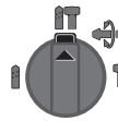
Position pour le perçage en frappe dans le béton et dans la pierre naturelle
