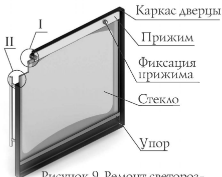
Рисунок 9. Ремонт светорозрачного экрана дверцы модели «Витра»
