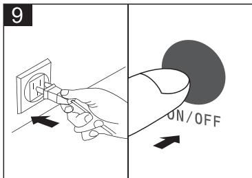
Вставьте вилку силового кабеля в розетку и включите прибор, нажав на кнопку On/Off [Вкл/Выкл].
