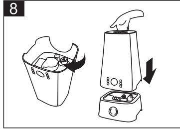
Плотно закройте крышку бака внизу и поместите его на основание. Теперь вода потечет из бака в основание. Если устройство в момент дополнения воды работало, то красная лампочка индикатора наполненности может гореть еще несколько секунд, пока основание не наполнится водой.
