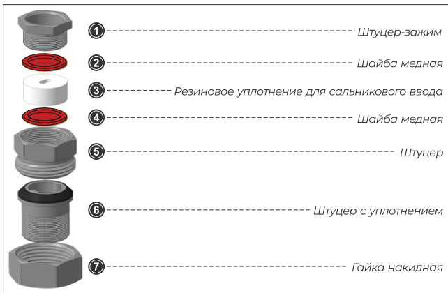
Рис. 2 Конструкция сальникового ввода
