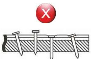
Рис. 3 Пример неправильной забивки гвоздей при монтаже продукции.
