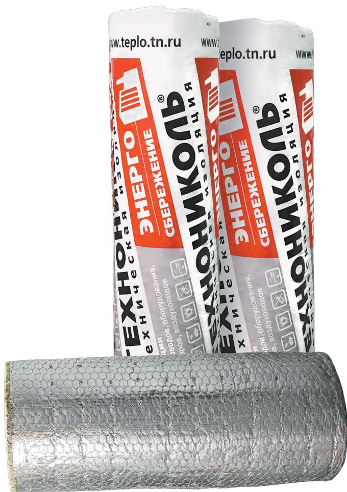
Мат Прошивной ТЕХНО 80 ГП Ф — это негорючий тепло-, звукоизоляционный прошивной мат из минеральной ваты, в основе которого лежит базальтовое волокно. С одной стороны мат покрывается гальванизированной сеткой с неармированной фольгой и прошивается металлической проволокой, которые придают жесткость изоляции и облегчают монтаж. Может так же выпускаться с односторонней обкладкой неармированной или армированной алюминиевой фольгой.
