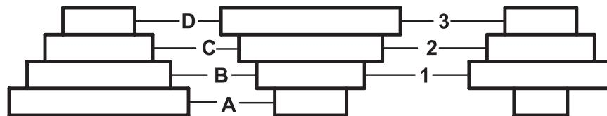
Рисунок Е — схема настройки необходимой частоты вращения шпинделя станка.
