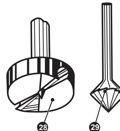
28. Сверло пробочное (цевковка)
