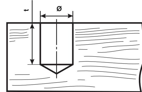
t — глубина отверстия (сверления), мм;
