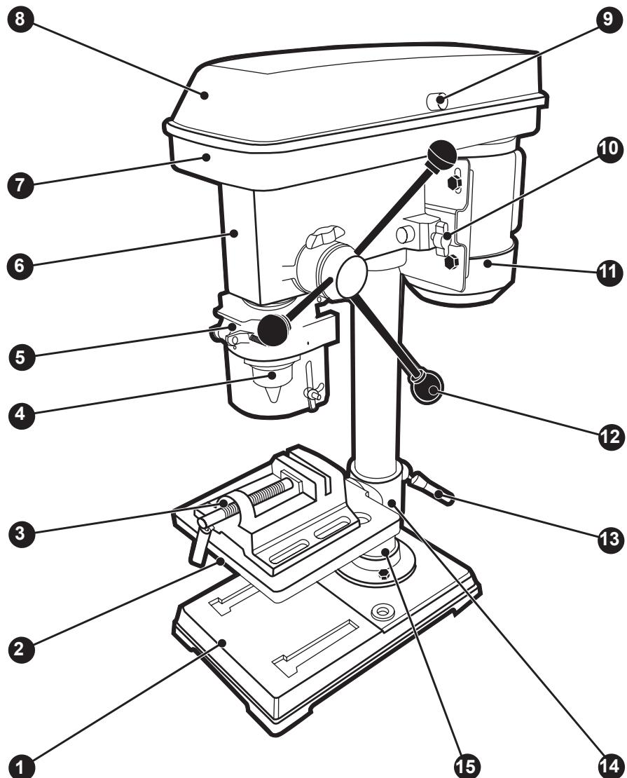
Рисунок А — общий вид станка.
