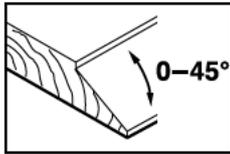
С помощью устройства настройки угла **23** установите требуемый угол скашивания четверти и площади.
