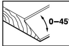
При скосі фальців і поверхонь встановіть необхідний кут скосу за допомогою регулятора кута **23**.
