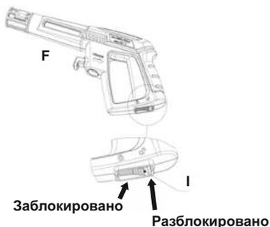
Данная мойка высокого давления оснащена предохранительным замком пистолета-распылителя. Когда мойка не используется, заблокируйте пистолет с помощью предохранительного замка, чтобы избежать случайных запусков устройства.
