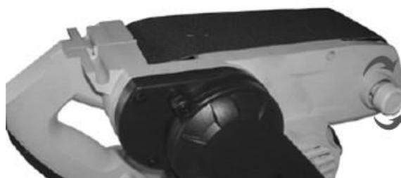
**ВНИМАНИЕ!** Лента должна плотно фиксироваться на основании; в противном случае произойдет чрезмерный износ шлифовальной ленты.
