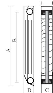
\*Примечание: теплоотдача указана при нормальных условиях - температура воды на входе  $t_{\text{вх}}=90^{\circ}\text{C}$ , на выходе  $t_{\text{вых}}=70^{\circ}\text{C}$ , при температуре воздуха  $t_{\text{возд}}=20^{\circ}\text{C}$ . Тепловой выход (Q) радиаторов при  $\Delta T$  отличающемся от  $70^{\circ}\text{C}$ , пересчитывается по формуле:  $Q = Q_{(\Delta T=70^{\circ}\text{C})} \cdot (\Delta T/70^{\circ}\text{C})^n$ , где  $n=1.30$ .
