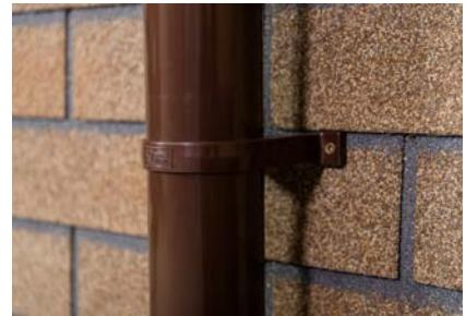
хомута подбирается в соответствии с отступом от фасада и толщиной теплоизоляции и должен заходить минимум на 50 мм в несущую конструкцию.
