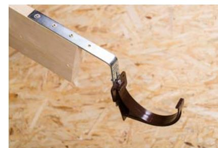
**3)** К стропильным ногам через удлинитель кронштейна боковой (применяется, когда монтаж кровли уже закончен).
