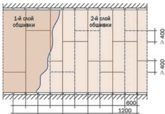
Рис. 14. Схема обшивки листами ГКЛ
