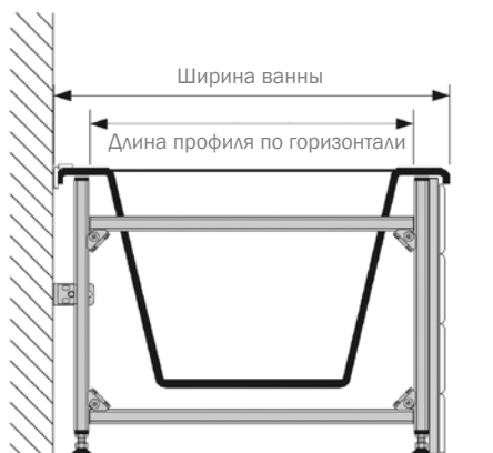
Приблизительный расчет длины/ширины конструкции для приставной ванны
