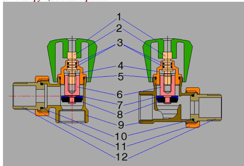
Корпус клапана 9 изготовлен из латуни CW617N методом горячей штамповки. К корпусу через уплотнительные прокладки из EPDM 5 и 10 присоединена латунная муфта вентильного узла 4 и патрубок полусгона 12. Патрубок полусгона крепится к корпусу с помощью накидной гайки 11.
