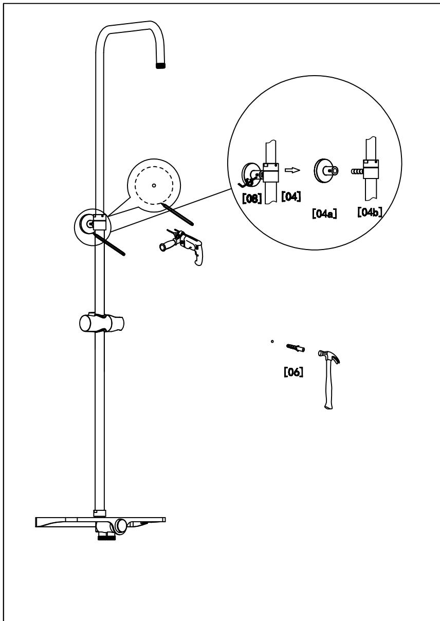
СХЕМА МОНТАЖА НАСТЕННОГО КРЕПЛЕНИЯ ДЛЯ ДУШЕВОЙ ШТАНГИ
