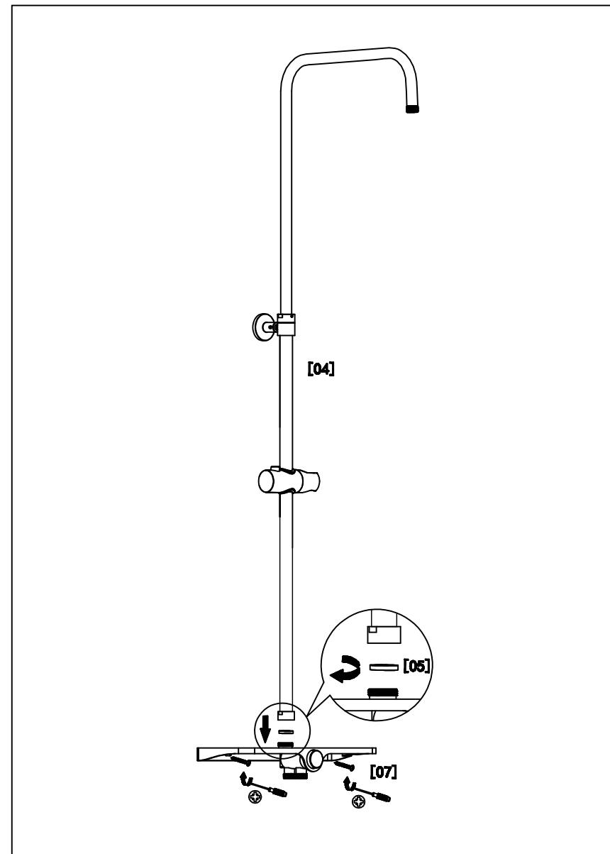
СХЕМА МОНТАЖА НАСТЕННОГО КРЕПЛЕНИЯ ДЛЯ ДУШЕВОЙ ШТАНГИ
