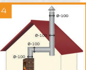
Диаметр дымового канала должен соответствовать мощности аппарата и на всем протяжении не должен быть менее диаметра выпускного патрубка аппарата.
