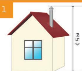
Общая высота дымового канала от колосника теплогенерирующего аппарата до устья трубы должно быть, как правило, не менее 5 м, что обеспечивает необходимое разрежение и создает тягу:
