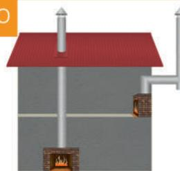
Для каждого теплогенерирующего аппарата следует, как правило, устраивать собственный дымовой канал. Допускается к одному дымовому каналу присоединять несколько теплогенерирующих аппаратов. При этом места врезки соединительных патрубков в дымовой канал обязательно должны находиться на разной высоте (не ближе 1 м).
