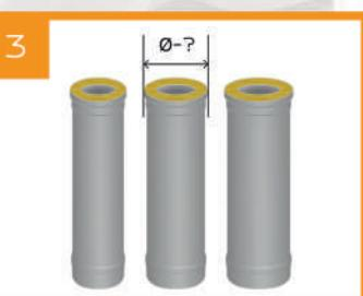
Диаметр дымового канала и соответственно изделий печных должен определяться исходя из требований ГОСТ 9817-95, согласно которым дымовой канал должен иметь площадь сечения не менее 8 см<sup>2</sup> на каждый киловатт мощности аппарата (печи, камина и др.).
