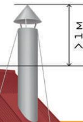
Выступающий над крышей дымоход высотой более 1 метра необходимо дополнительно укреплять растяжками, способными выдержать резкие порывы ветра.
