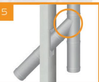
Дымовые каналы выполняются вертикальными без уступов и горизонтальных участков. При необходимости допускается выполнять не более двух отклонений от вертикали на угол не более 30° с относом не более 1 м, чтобы обеспечить удобство и эффективность чистки канала через оголовок. При наличии прочистных люков в непосредственной близости от изгиба канала допускается увеличивать угол отклонения канала от вертикали до 45°, а относ - до 1,7 м.
