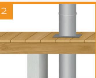
В основном отапливаемом помещении могут быть применены одноконтурные трубы. В случае прохождения дымоходной трубы через стенные перекрытия, для обеспечения пожарной безопасности, необходимо применять трубы-сэндвичи (двухконтурная труба), изолированные потолочно-проходным узлом (ППУ) и негорючими материалами.
