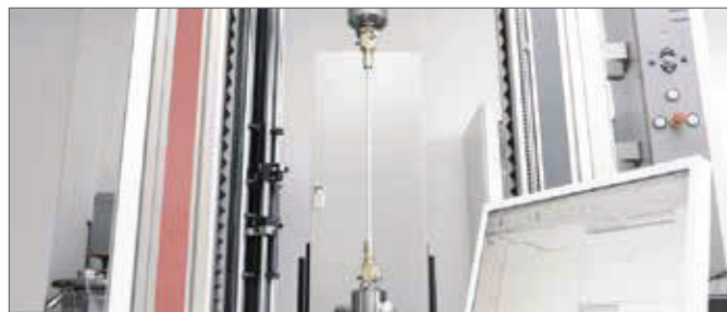
Рис. 2-3 Ход испытания на растяжение
