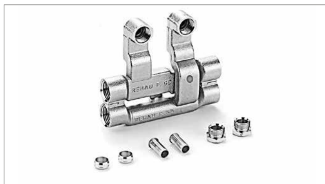
Рис. 16-5 Крестовина SL-RAUTITAN Rp 1/2" - 12 - Rp 1/2" в комплекте
