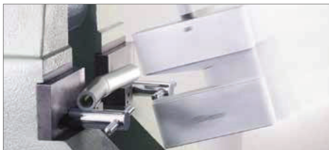
Рис. 2-2 Универсальная труба RAUTITAN flex в установке по испытанию ударной вязкости
