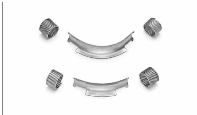
Рис. 11-3 Фиксаторы поворота (водоснабжение) (3–4 x Ø) – 90° или 45° для изгиба труб Ø 16–32
