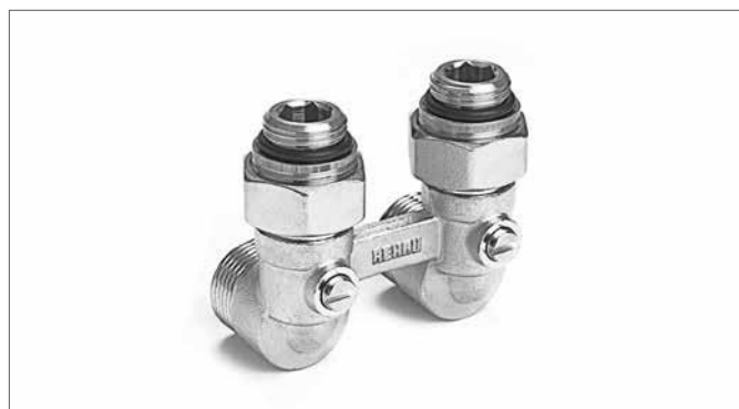
Рис. 14-9 Блок шаровых кранов (угловой) с ниппелем G 1/2" x G 3/4"
