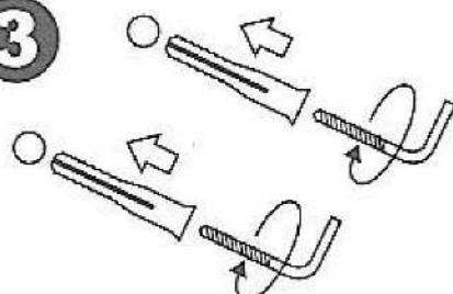
Вставьте дюбеля в отверстия и вверните в них крепежные элементы, оставив зазор 0,7 см между стеной и головкой крепежного элемента
