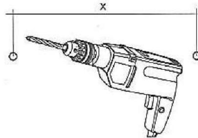
Просверлите в стене отверстия под крепежные элементы, используя сверло, соответствующее диаметру дюбеля
