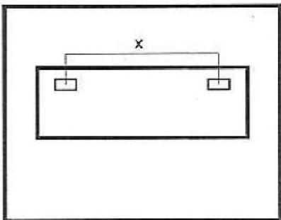
Замерьте расстояние (Х) между центрами крепежных отверстий и перенесите разметку на стену, определив горизонталь
