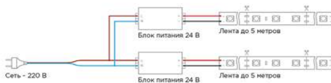
Параллельное подключение 10 метров ленты с двумя источниками питания
