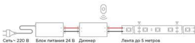
Подключение 5 метров ленты с одним источником питания к диммеру
