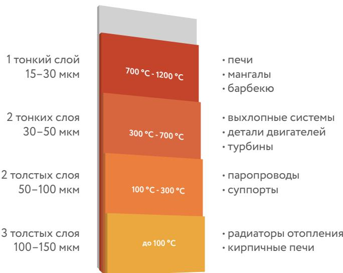
Чем толще слой, тем выше стойкость к коррозии, но чем выше температура нагревания, тем тоньше должен быть слой. При превышении допустимой толщины возможно растрескивание нанесенного покрытия.
