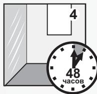
При проведении работ и в течение последующих 48 часов  $t^{\circ}$  воздуха и основания не должна опускаться ниже, чем  $+5^{\circ}\text{C}$ . Рекомендуемая влажность основания не более 10%.
