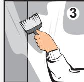
Перед началом работы клей тщательно перемешайте. При склеивании изделий нанесите клей кистью или валиком тонким слоем на одну из склеиваемых поверхностей. Поверхности выдержите под давлением до полного высыхания (не менее 24 часов).
