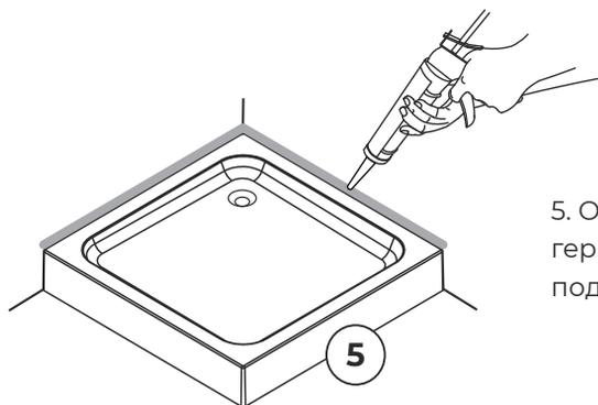
5. Обработать силиконовым герметиком места примыкания поддона к стене.
