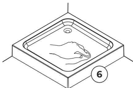
6. Не допускайте попадания воды на герметик в течение 24 часов.
