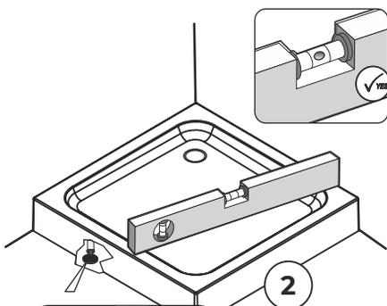
2. Проверить с помощью уровня плоскости бортов, они должны быть строго горизонтальны, для этого необходимо отрегулировать по высоте ножки и зафиксировать их положение контргайками, предварительно убедиться, что все опоры касаются пола.
