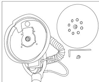
**ВНИМАНИЕ!** Устанавливайте на держатель только рекомендованные шлифовальные колодки. С целью оптимальной работы дайте блоку поработать несколько минут с более низкой скоростью, чем рабочая, чтобы шлифовальная колодка «притерлась» к уплотняющей поверхности держателя.
