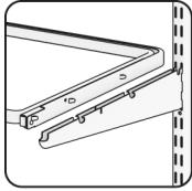
6 Расположите проволочную корзину внутри рамы.
