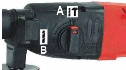
Для сверления бетона рекомендуется использовать функцию перфоратора.
