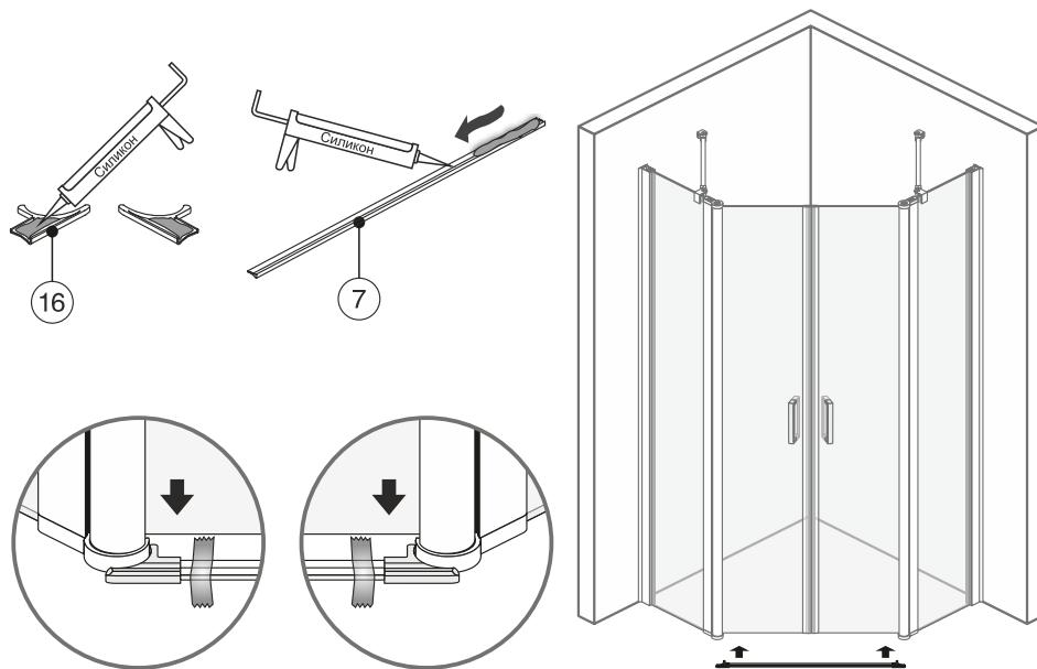
**Предупреждение!** После установки не используйте изделие по крайней мере еще 24 часа, для того чтобы силиконовый герметик полностью высох.
