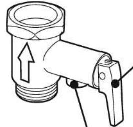
Рычаг предохранительного клапана
