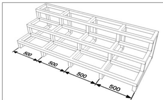
Рис. 19 – каркасное основание
