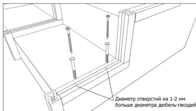
Рис. 20 – монтаж конструкции лаг на бетонное основание
