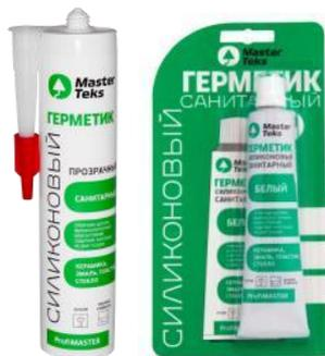
Высококачественный однокомпонентный силиконовый герметик кислотного типа с противогрибковыми и противоплесневыми добавками, затвердевающий под воздействием влажности воздуха. Рекомендуется для герметизации в помещениях с повышенной влажностью (ванные комнаты, душевые кабины, кухни, подвалы и др.).
