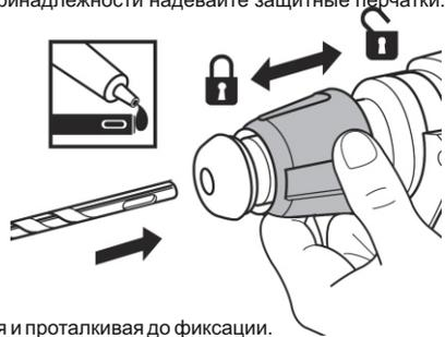
Стопорная муфта используется для установки и извлечения сверла и зубила.
