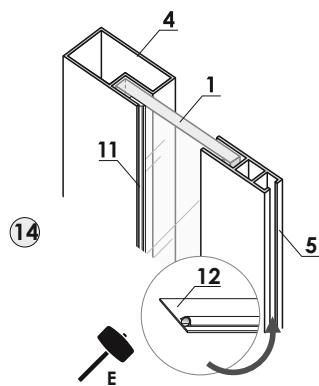
15. Закрепите между собой собранную раму (рамочный, стоечный и направляющие профиля) и установочный профиль с внутренней стороны ширмы шурупами 3,5x9,5 (полусфера со сверлом). Используйте декоративные заглушки (рис. 15).
