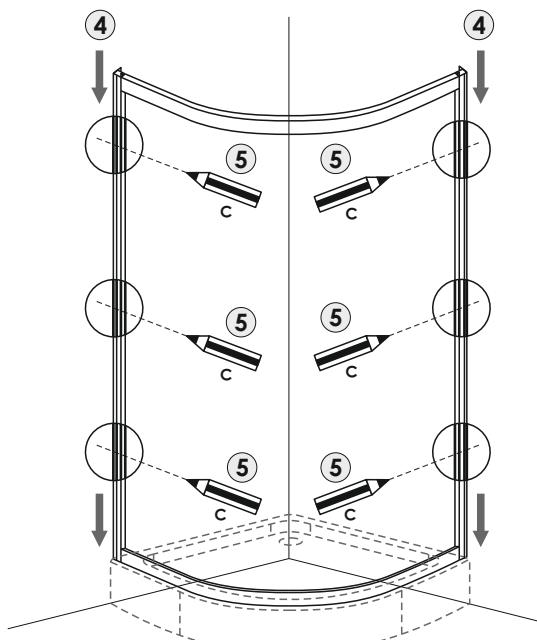
6. Просверлите стены и установочный профиль (рис.6).
