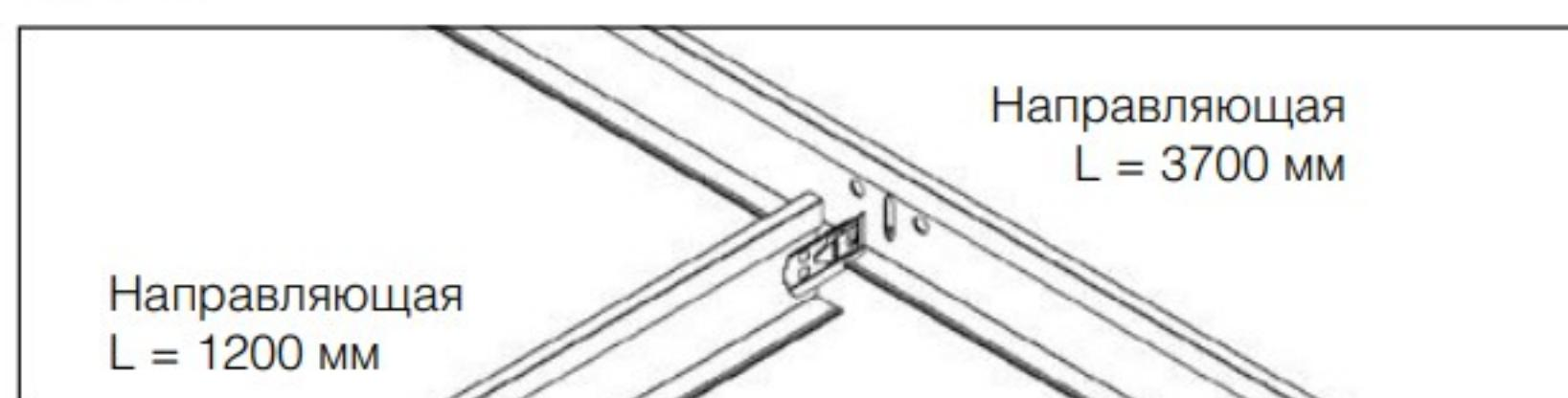
**ВНИМАНИЕ!** Светильники, сплинкеры, датчики сигнализации, кондиционеры, выходящие на лицевую часть подвесного потолка, должны крепиться на независимых подвесах! В помещениях запрещается крепиться к воздуховодам и другим коммуникационным системам. В помещениях с повышенной влажностью запрещается устанавливать Т-профили T-24 E, T-24 NORMA, T-24 Албес. В помещениях с повышенной влажностью подвесы должны быть дополнительно окрашены.
