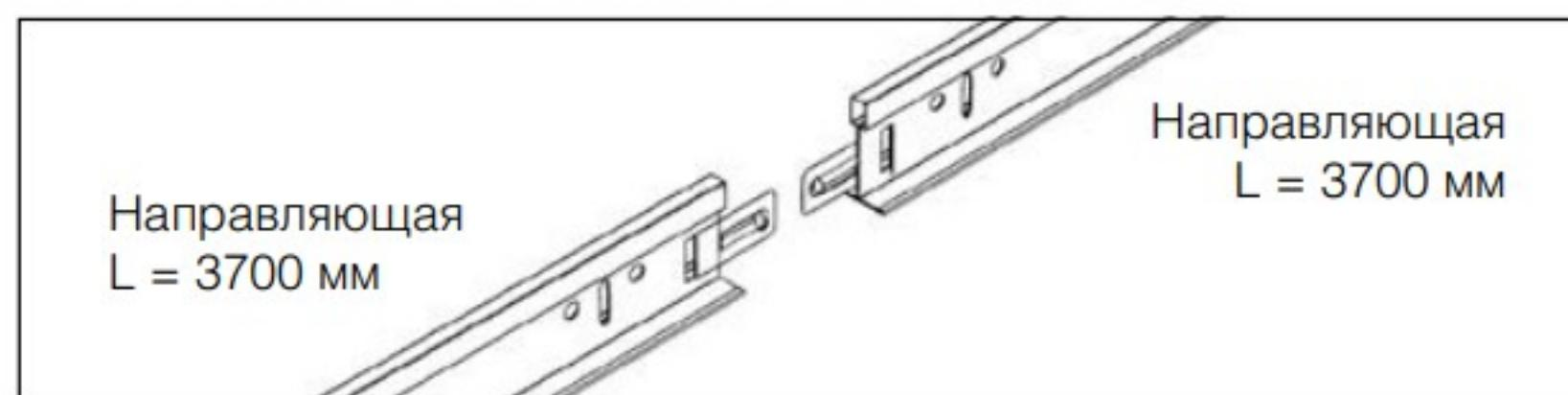
**Шаг 6.** По завершениюстыковки профилей, производится их выравнивание по уровню в одной плоскости, которую образует уровень периметра. Делается это с помощью регулировки вверх-вниз подвесов, на которых закреплены основные направляющие.
