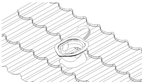
4. Установить проходной элемент на кровлю и закрепить подходящими для данного типа кровли самонарезающими винтами в последовательности, показанной на рисунке.
