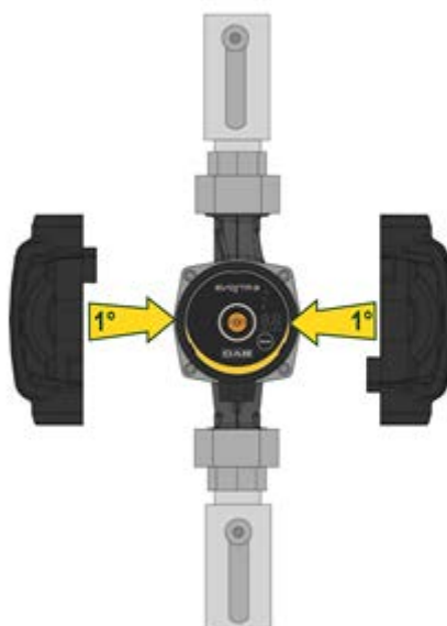
Figura 7: Isolamento do corpo da bomba
