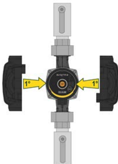
Image 7: Isolation du corps de pompe
