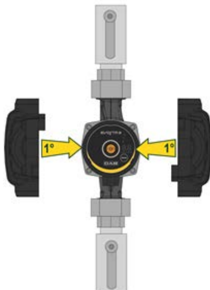
Obrázek 7: Izolace tělesa čerpadla
