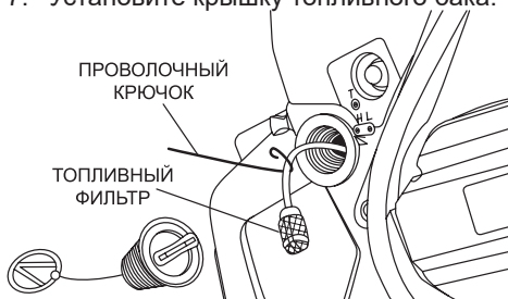
Рис. 19 Обслуживание топливного фильтра
