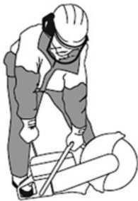
Рис. 8 Положение оператора при запуске двигателя
