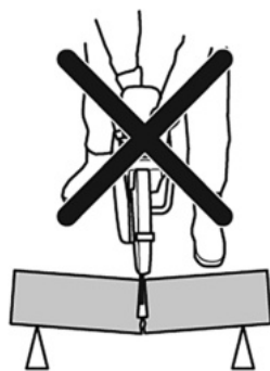
Рис. 15 Отдача при защемлении диска
