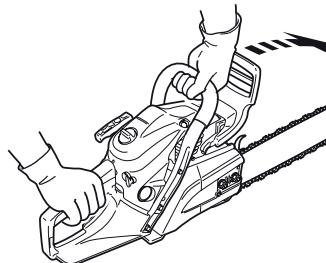
Для остановки двигателя бензопилы в штатном режиме, отпустите курок газа, дайте поработать двигателю на холостых оборотах до 5 секунд и переведите клавишу зажигания в положение ВЫКЛ.
