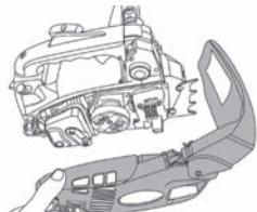
Модель PT 3816 установите упор со стороны глушителя, для этого открутите винт крепления глушителя, установите упор между креплениями и проушиной глушителя, и зафиксируйте его винтами.
