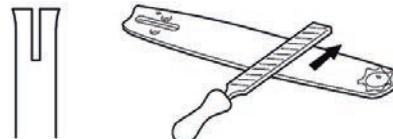
Для равномерного износа шины и продления срока ее эксплуатации переворачивайте шину каждые 8 часов работы. Это позволит равномерно распределять износ полотна. Держите паз шины и отверстие для смазки в чистоте.
