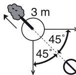
Прежде чем приступить к валке дерева определите направление его падения, учитывая расположение естественного наклона, преобладающего расположения ветвей. Учтите расположение других деревьев, строений и линий электропередач. Расчистите зону вокруг дерева.
