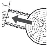
При работе бензопилой без применения упора возможно защемление цепи вдоль верха пильной шины - это приводит к отбрасыванию назад, непосредственно в сторону оператора.
