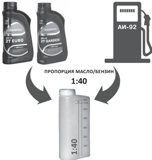
Заполните топливный и масляные бачки. Если вручную открутить крышку топливного или масляного бака тяжело, вставьте прилагаемый торцовый ключ в паз на крышке и поверните его против часовой стрелки.
