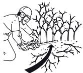
Тонкие ветви легко могут застрять между звеньями цепи и поранить оператора, будьте предельно осторожны при обрезке мелкого кустарника и тонких ветвей деревьев.
