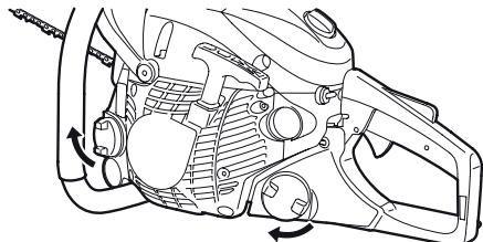
**ПРЕДУПРЕЖДЕНИЕ:** Наполняйте топливный бак не более, чем на 1 см ниже края заливного отверстия, во избежание протечки оставьте место для расширения топливной смеси.
