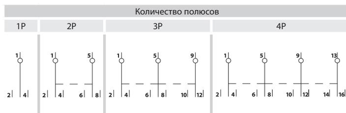
Среднее положение рукоятки переключателя фиксирует нулевое положение контактов.
