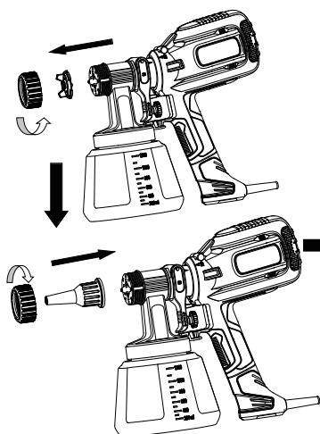
**Инструкции по замене соединения для продувки пыли:** Вращайте прижимную гайку против часовой стрелки, снимите воздушный колпачок, снимите форсунку распылителя, замените на насадку для продувки пылии, затяните черную прижимную гайку по часовой стрелке.
