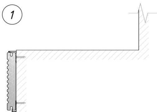
Рис. 7.1. Фиксация подступёнка начальной и конечной клеммами Рис. 7.2. Установка F-профиля
