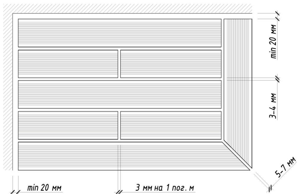
Рис. 6.2. Зазоры укладки террасной доски
