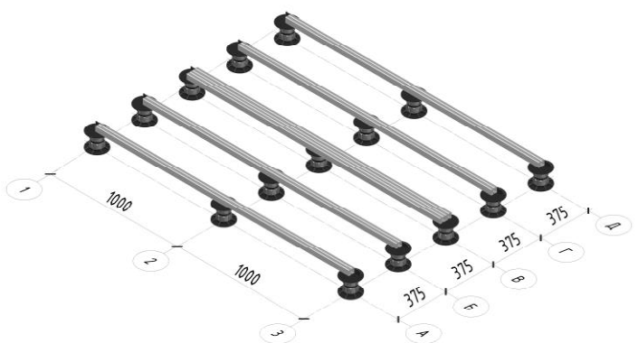
Рис. 3.3. Схема расположения регулируемых опор при использовании алюминиевой лаги 100
