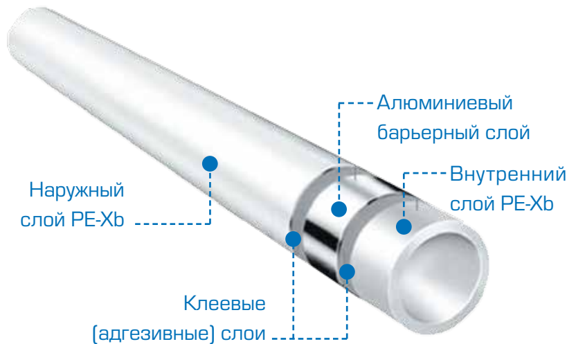
Рис. 2.2. Пятислойная металлополимерная труба РЕ-Хв/АI/РЕ-Хв
