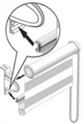
Вставьте фиксирующую профильную планку в нижние пазы навесного кронштейна. Края цепочного механизма вставьте в кронштейны.
