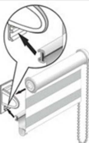
Вставьте фиксирующую профильную планку в нижние пазы площадки. Края цепочного механизма вставьте в кронштейны.
