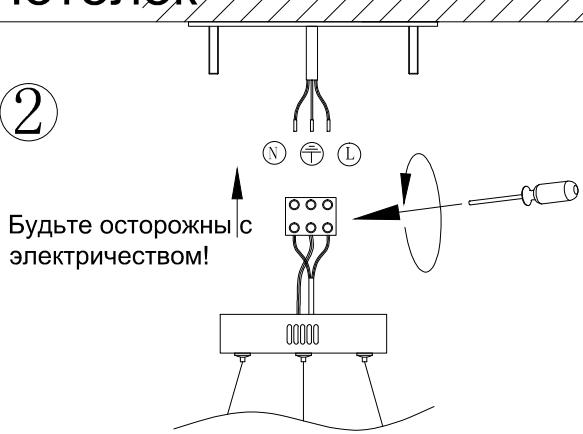
Затем следует подключить светильник к трехпроводной линии питания. Обратите внимание на расположение фаз и заземления.
