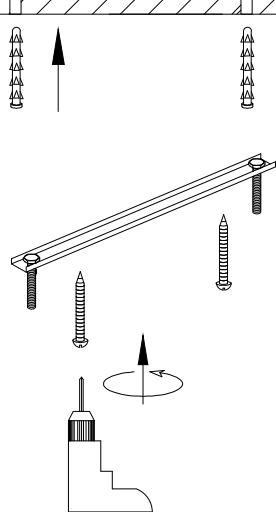
Прежде всего необходимо с помощью саморезов прикрепить к потолку подвесную панель для ламп и фонарей.
