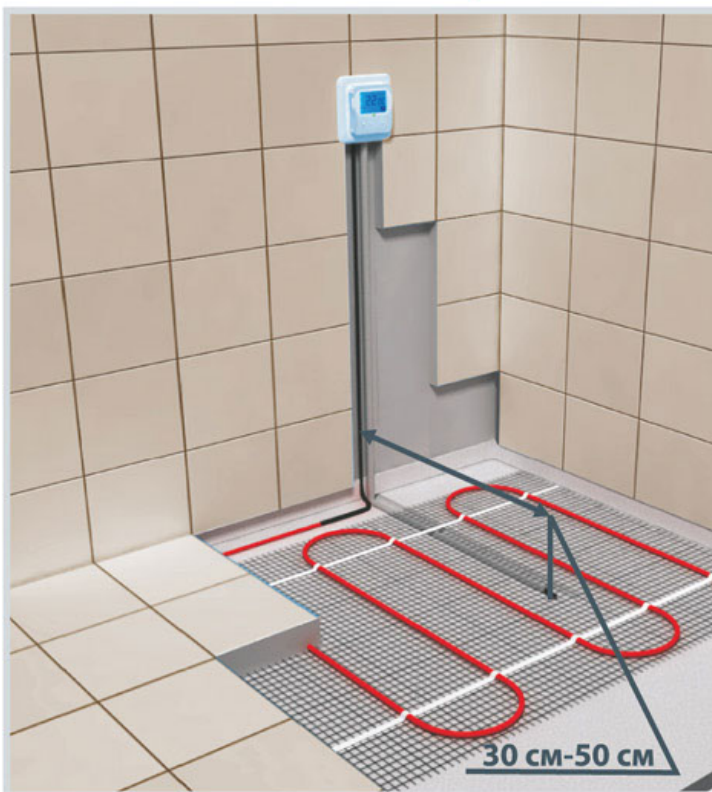
Схема укладки датчика температуры в гофрированной трубке
