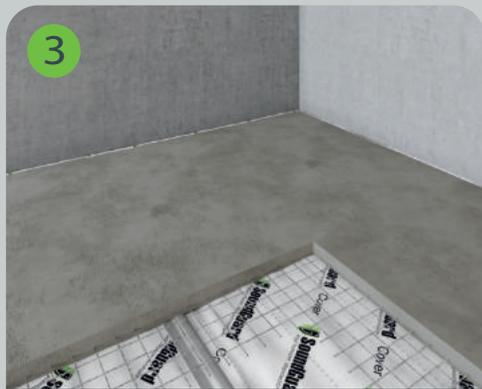
Поверх звукоизоляционного материала выполняется цементно-песчаная стяжка толщиной минимум 60 мм. Стяжка должна быть армирована сеткой в 1/3 ближе к низу слоя.
