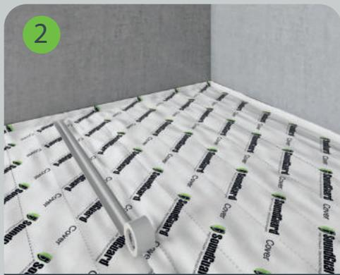
Стыки материала проклеиваются клеевой лентой водостойкой армированной SoundGuard.
