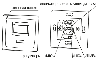
Рисунок 15 – Конструкция датчика движения ДД-035
