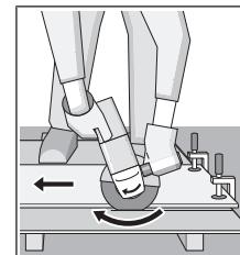
Всегда водите электроинструмент против направления вращения. В противном случае существует опасность **не-контролированного** вырывания инструмента из прорези. При резке профилей или четырехграных труб начинайте рез на наименьшем поперечном сечении.
