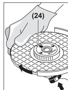
Ажарлау шпинделін (1) бекіту үшін шпиндельді бекіту түймесін басыңыз. Тез қысыш гайканы бекемдеу үшін ажарлау дисқісін күш салып сағат тілінің бағытына қарсы бұрап арқылы шығаруға болады.
