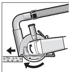
Включите электроинструмент и приставьте переднюю часть направляющих салазок к обрабатываемой заготовке. Ведите пневматический инструмент с равномерной, рассчитанной на обрабатываемый материал подачей. При обработке особо
