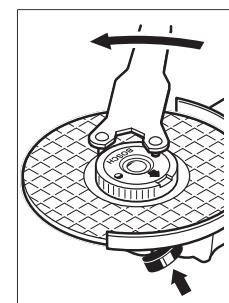
Дұрыс бекітілген, зақымдалмаған тез қысыш гайканы сақинаны сағат тілінің бағытына қарсы бұрап арқылы шығаруға болады. Ешқашан қатты бекемделген тез қысыш гайканы тістеуікпен бұрап алмаңыз, екі бүйірлік тесігі бар гайка кілтін пайдаланыңыз. Гайка
