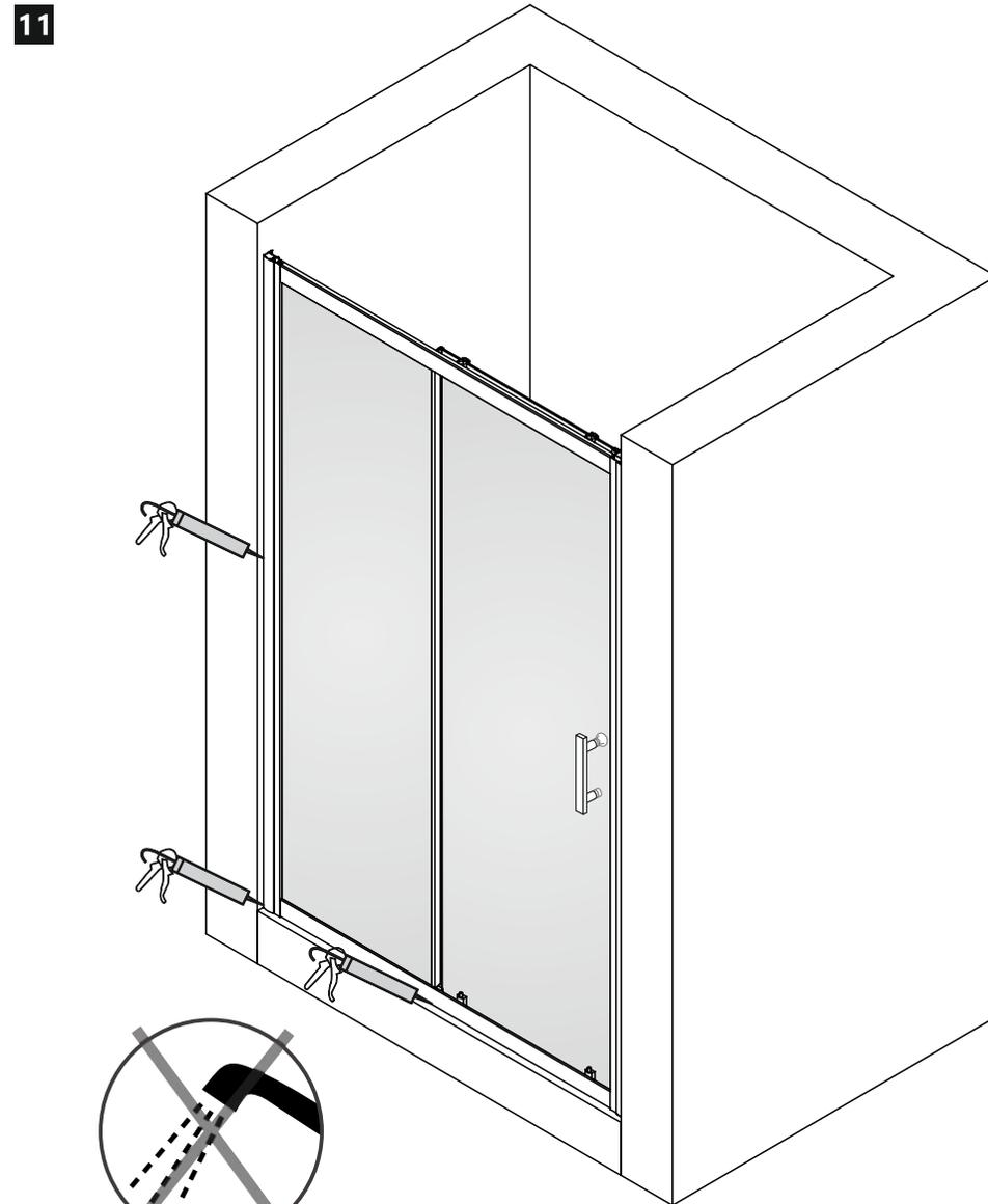
**Предупреждение!** После установки не используйте изделие по крайней мере еще 24 часа, для того чтобы силиконовый герметик полностью высох.
